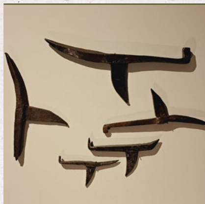
Vari esempi di "Anghiar": ganci posti all'estremità di lunghe aste di legno, utilizzate per la movimentazione dei tronchi
