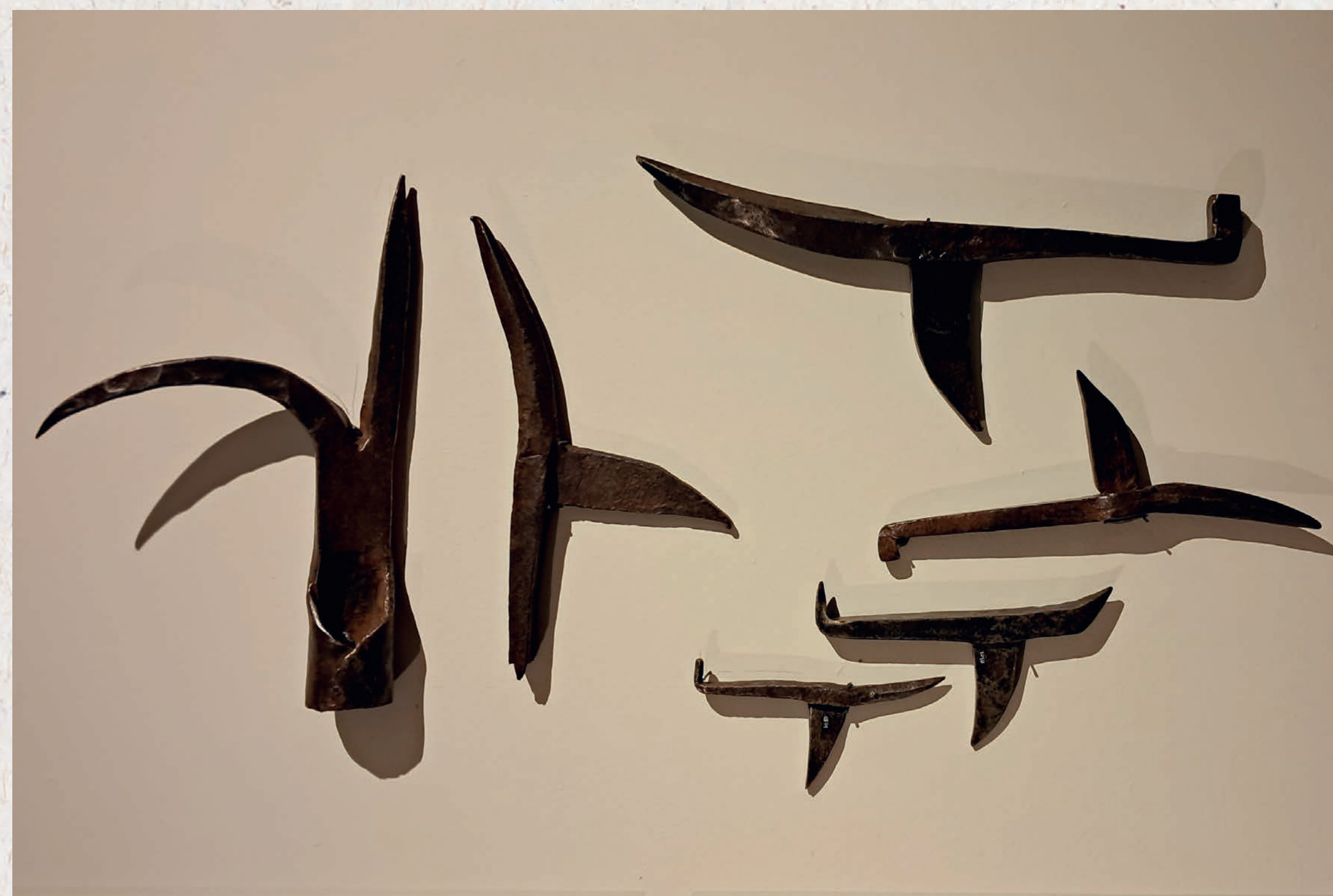
Vari esempi di "Anghiar": ganci posti all'estremità di lunghe aste di legno, utilizzate per la movimentazione dei tronchi
